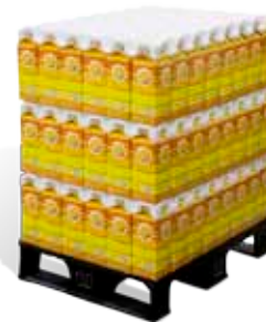
Juiceförpackningarna staplas på varandra och som mellanlägg används en formgjuten EPS från Sundolitt.
